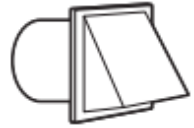
Hotte d'évacuation inclinée
