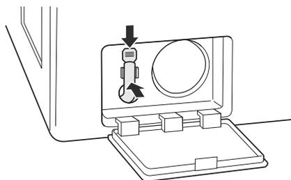
**7** Insérez le filtre de la pompe de vidange et tournez-le dans le sens des aiguilles d'une montre.
