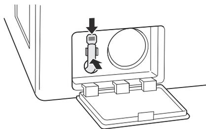
**7** Insérez le filtre de la pompe de vidange et tournez-le dans le sens des aiguilles d'une montre.
