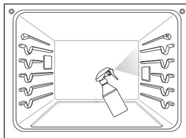
**5** Vaporisez ou versez l'eau restante (8 oz or 240 ml) dans le centre inférieur de la cavité du four. Les renforcements de la partie inférieure du four doivent être entièrement recouverts afin d'immerger toute la saleté. Ajoutez de l'eau au besoin.
