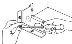
Installer le dispositif antibasculement
