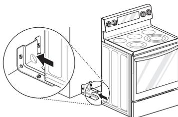
Enclencher le dispositif antibasculement
