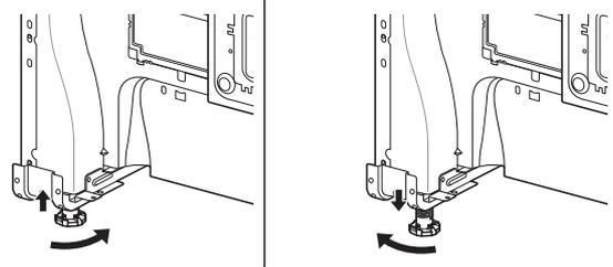
Utiliser un niveau pour vérifier les réglages. Placer le niveau en diagonale sur la grille du four pour vérifier le niveau dans chaque sens.
