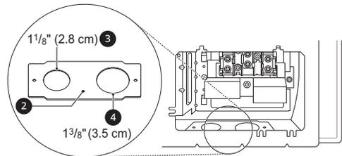
Para instalaciones con cable de alimentación **5**, enganche el pasacables sobre el orificio para cable de alimentación de 1 3/8 pulg. (3.5 cm), ubicado por debajo de la parte trasera del horno. Inserte el
