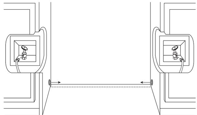
**IMPORTANT :** Passer la conduite d'eau le long du mur et la fixer avec du ruban adhésif afin d'éviter qu'elle ne s'entortille lors de la mise en place du réfrigérateur.
