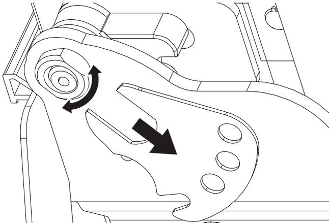
4. Faire tourner les bagues situées sous la charnière – utiliser une clé à fourche de 1/2 po. La rotation de la bague vers la gauche provoque un abaissement de la porte. La rotation de la bague vers la droite provoque un soulèvement de la porte.
