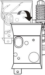
**5** Insérez un serre-câbles de 3/8 po (2) dans la boîte de jonction en le faisant passer par le trou. Serrez l'écrou à œil (3) pour le fixer.
