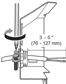
**7** Tirez les fils existants par les ouvertures de la boîte de jonction. Serrez les deux vis (4) pour replacer la boîte de jonction dans l'appareil.
