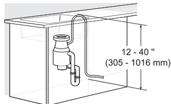
**Raccordement à un broyeur sans coupe antirefoulement**
