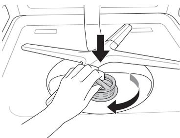
l'assemblage, tournez le filtre fermement jusqu'à entendre un clic.
