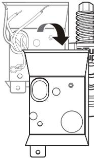
**5** Insérez un réducteur de tension de 3/8 po **2** dans la boîte de jonction en le faisant passer par le trou. Serrez l'écrou à œil **3** pour le fixer.
