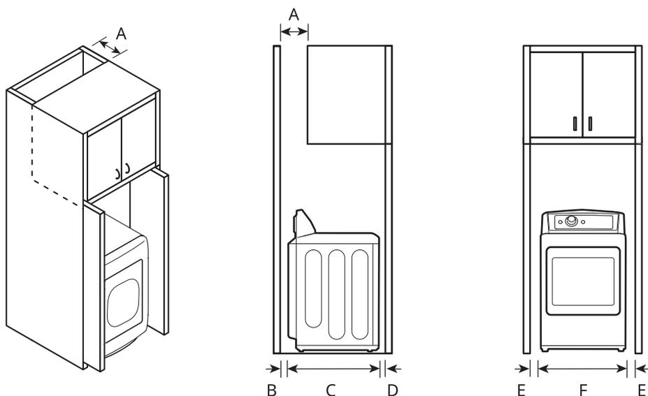
S'il s'agit d'une installation dans une armoire avec porte, des ouvertures de ventilation minimales doivent être pratiquées en haut de la porte de l'armoire.
